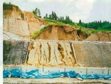
左：黒土 中央：真砂土 右：調整土砂 エロージョン防止対策
